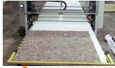
09 Servo motor driven conveyors and glue guns Servo motor kontrollü konveyör ve yapıştırma kafası hareket sistemi
