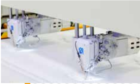
01 High quality sewing head with worldwide parts availability: Dürkopp Adler Dünyaca bilinen yüksek kalite dikiş kafası: Dürkopp Adler
