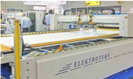
11 Optical barriers for human safety Optik bariyer sistemi ile üst düzeyde iş güvenliği
