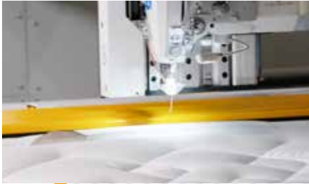
04 Advanced side cutters on the sewing head to cut precisely near the stitch Dikis kafasına monte yan kesiciler ile maksimum hassasiyette kenar kesimi
