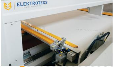
04 Automatic park positioning when top or bottom thread finish Alt veya üst ip koptuğunda otomatik park pozisyonu
