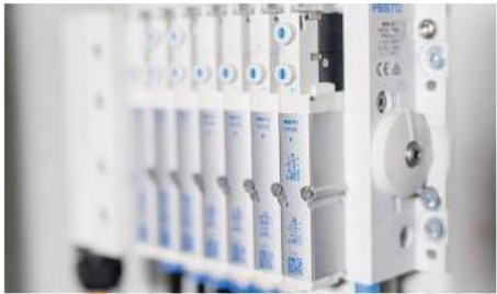
12 Lifelong Pneumatic System with Low Air Consumption Düşük hava sarfiyatlı uzun ömürlü Festo pnömomatik sistemi
